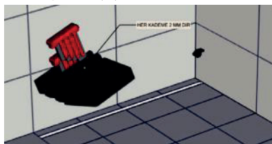
Instalujte plastové koncovky a upravte podle výšky dlažby, změnou polohy červených částí zobrazených na fotografii lze upravit (nastavitelné nožičky).
